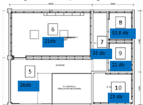
Gambar 16. Hasil Pengukuran Tahap II-2 Penerimaan Kuat Suara di Ruang Lain dari Sumber Suara di R.8
